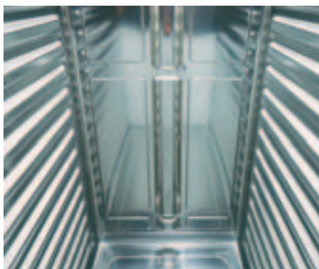
Faciles à laver : intérieur soudé étanche avec glissières embouties et angles arrondis (exécution hygiène H3).
