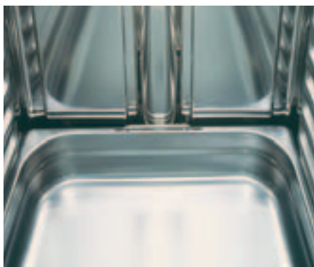
Faciles à chauffer : le chauffage à circulation d'air répartit parfaitement la chaleur grâce au guidage par cheminée (les bacs Gastro-norme ne vont pas jusqu'à la paroi, formant ainsi une « cheminée »).
