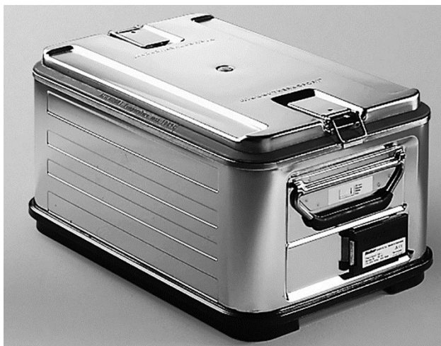
TP 105 L verwarmbaar – oppervlakteverwarming in het corpus in het bodemgedeelte en circa 2/3 hoogte aan de zijkant
